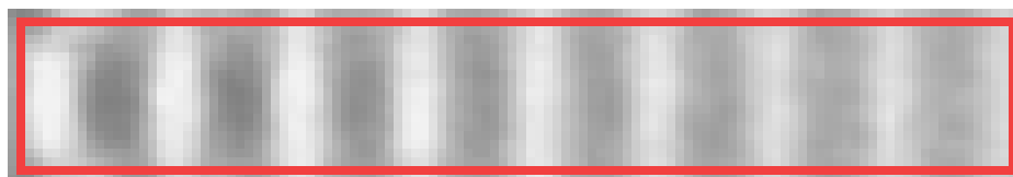
Hình 2. Hình ảnh của sóng nước có biên độ (cường độ) giảm dần
